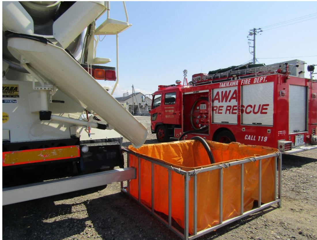
③給水した簡易水槽から吸管で揚水する様子
